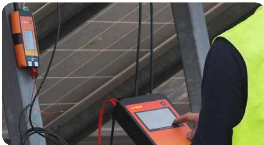
Figura 3: Pantalla medición curvas I-V, trazador de curvas E-1500, módulo bifacial.
