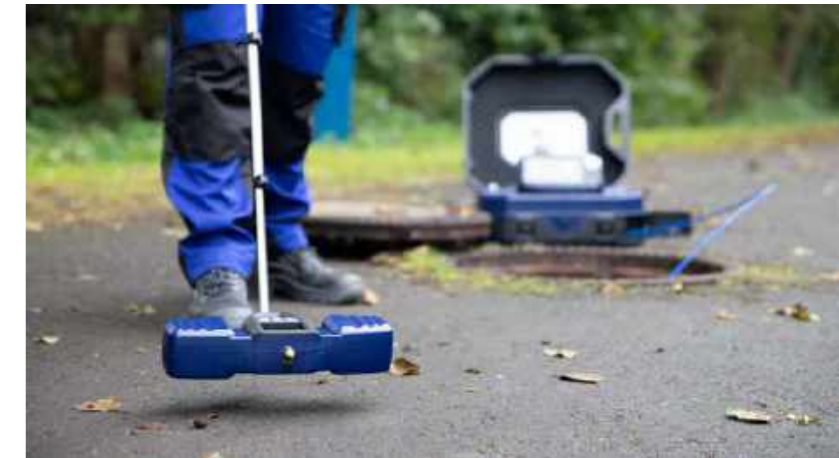
Con el localizador Wöhler L200, el cabezal de la cámara puede ser localizado con una precisión milimétrica.
