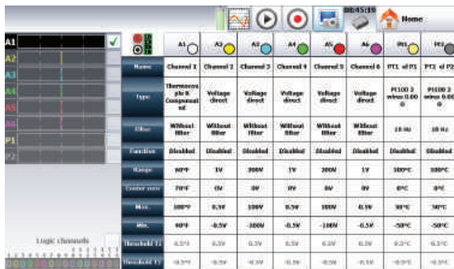
La configuración de los canales muestra todos los parámetros en una sola pantalla.
