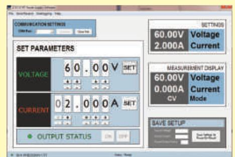
Utilice el software de aplicaciones de BK Precisión, disponible para descarga en [www.bkprecision.com](http://www.bkprecision.com). Este software provee un panel frontal virtual y una función de registro de datos simple para guardar datos en un archivo de texto o CSV.
