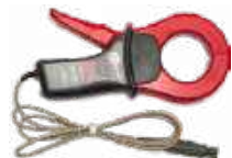
Pinza C-4A (Ø 52 mm) 1000 A AC
