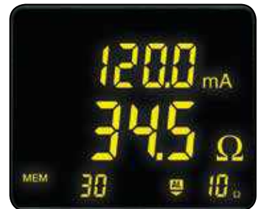
Indica el umbral de la alarma de corriente o tensión junto con la dirección de impedancia
