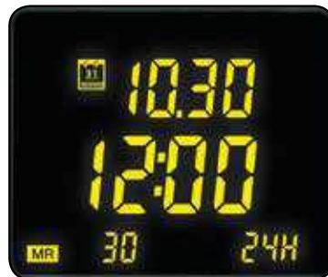
Pantalla de fecha y hora del almacenamiento de mediciones
